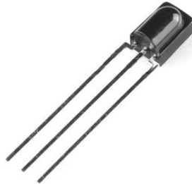
Gambar 2.9. LED untuk menangkap Cahaya infrared dari remote yang terpasang diperalatan elektronik misalkan televisi[12]
