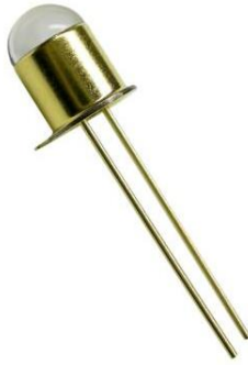
Gambar 2.8. Ligth Emiting Dioda (LED) sebagai sumber cahaya infrared untuk remote[11]
