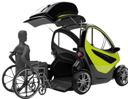
Gambar 3.1 Design kendaraan roda empat untuk penyandang cacat
