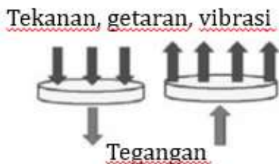
Gambar 5. 5. Proses berkebalikan efek piezoelektrik
