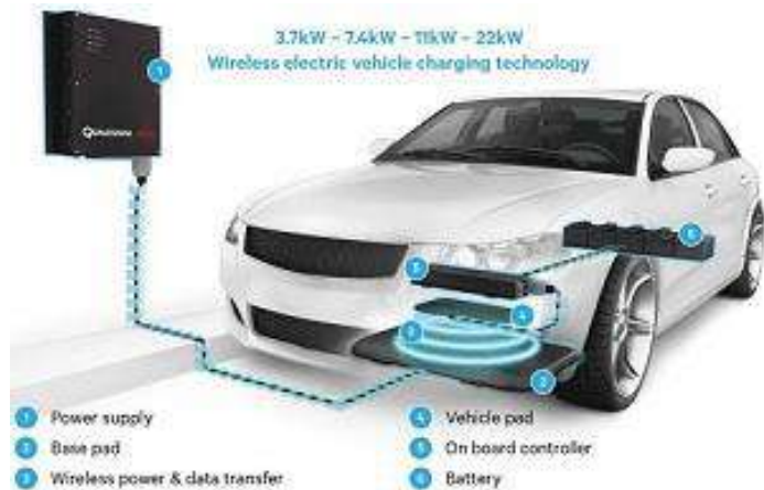
Gambar 3. 6. Pengisian baterai kendaraan listrik secara nirkabel
