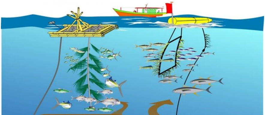
Gambar 2.5. Ilustrasi Pemasangan Payaos di Perairan Sumber : (Rosana and Sofijanto, 2015)
