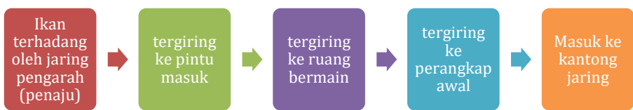
Gambar 9.1. Alur proses ikan tertangkap dengan set net
