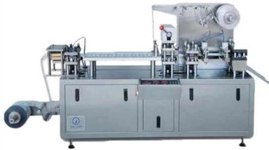
Gambar 5.3 Mesin Pengemasan Blitser Kapsul (Sumber: Trustar)
