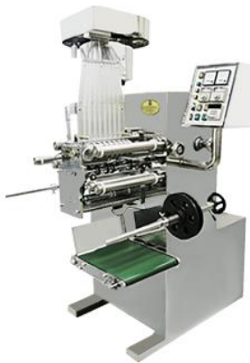
Gambar 5.3 Mesin Pengemasan Blitser Kapsul (Sumber: Trustar)
