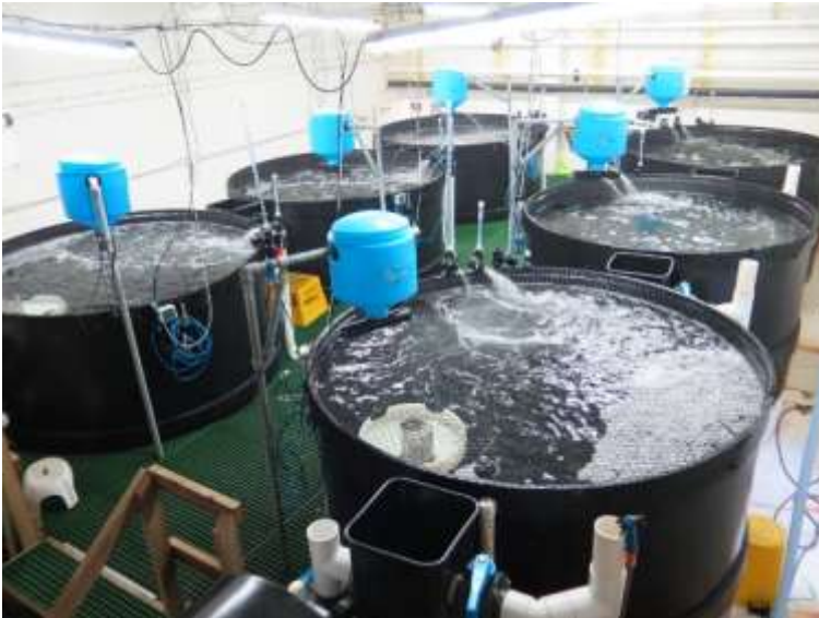
Gambar 1.5. Salah satu model Pembenihan Ikan dengan Teknologi Recirculating Aquaculture System (RAS) di Indonesia
