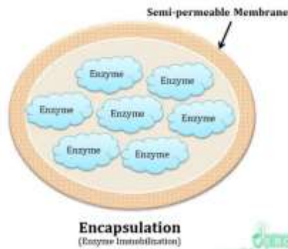
Gambar 4.7. Imobilisasi enzim dengan teknik mikrokapsul Sumber : www.easybiologyclass.com
