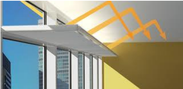
Gambar 6.3. Contoh light shelf atau rak cahaya
