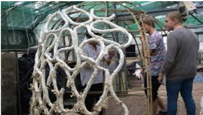
Gambar 3.6. Struktur yang Memanfaatkan Jamur Mycelium (Sumber: https://www.greeners.co/ide-inovasi/jamur-struktur-bangunan/ , akses 30 November 2025)
