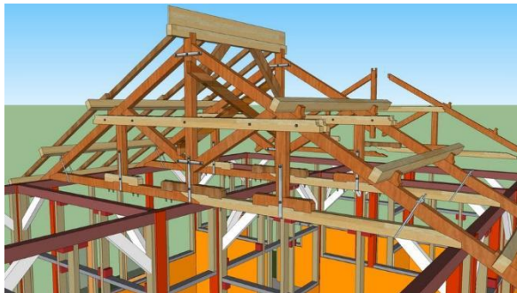
Gambar 10.1. Ilustrasi rangka kuda-kuda pada perumahan sederhana
