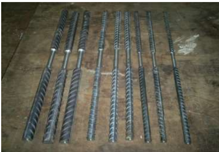
Gambar 6.5. Contoh spesimen uji kuat tarik baja tulangan (Wuaten, 2007)
