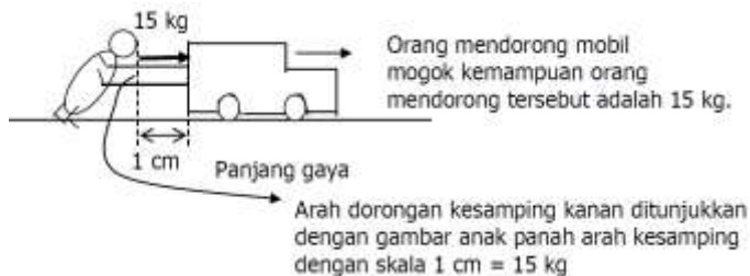
Gambar 5.3. Ilustrasi beban horizontal dari dorongan
