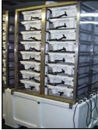
Gambar 3. 4. Sistem Depurasi Kerang Skala Kecil (A) Wadah Bertingkat Vertikal (B) (Helm et al. , 2004)
