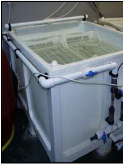
Gambar 3. 4. Sistem Depurasi Kerang Skala Kecil (A) Wadah Bertingkat Vertikal (B) (Helm et al. , 2004)
