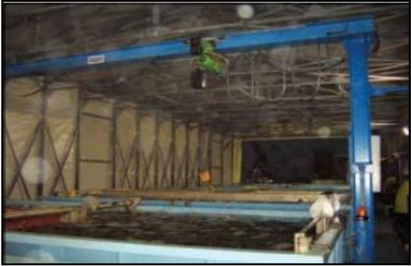
Gambar 3. 6. Mesin untuk Loading dan Unloading Kerang (Helm et al., 2004)
