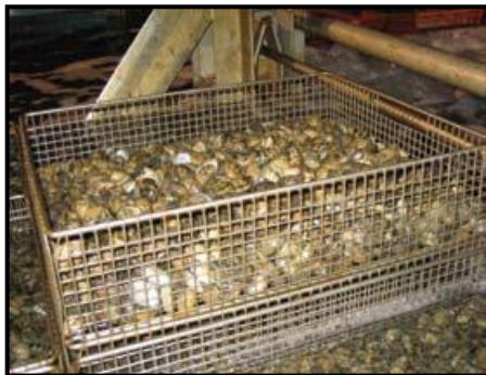
Gambar 3. 5. Jenis Rak yang Dipakai pada Instalasi Depurasi Kerang (Helm et al. , 2004)
