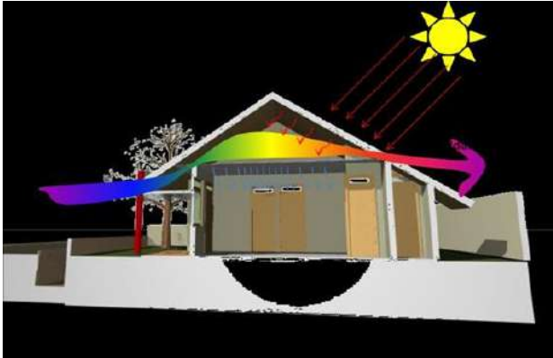
Gambar 3.6 Ventilasi Atap Pada Plafond
