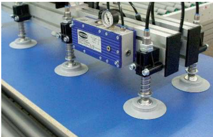
Gambar 2.48. Model Gripper menggunakan Vakum (Sumber : Education Centre 2015)
