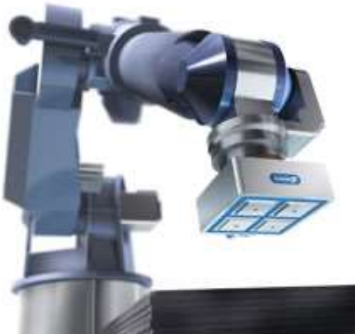
Gambar 2.47. Model Gripper Menggunakan Magnetik (Sumber : Education Centre 2015)
