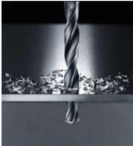
Gambar 2.88. Proses pengeboran material
