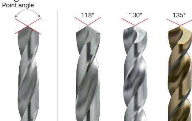
Gambar 2.150. Sudut mata bor setelah diasah (Sumber : https://gofir.co.id/mata-bor-twist-drill/ )
