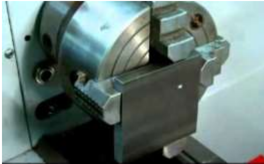
Gambar 2.122. Persiapan pengeboran pada bidang yang tidak simetris, material dicekam pada cekam 4 (Sumber : Pinterest.com)
