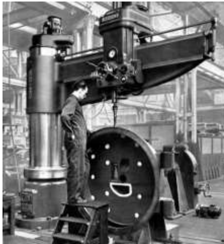
Gambar 2.110. Radial drilling mesin digunakan untuk mengebor casing pompa dengan diameter lebih dari 1 meter. ( sumber : https://id.pinterest.com/ )
