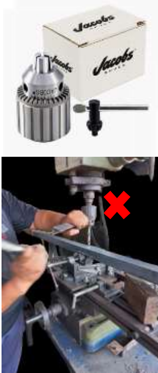
Gambar 2.153. Memasang matabor harus menggunakan kunci, memasang mata bor tidak menggunakan alat yang sesuai adalah tindakan tidak aman
