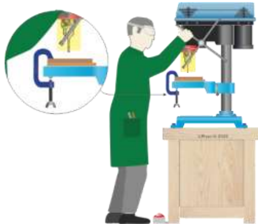
Gambar 2.157. Teknik menjepit benda kerja dengan klem “C” (sumber : https://technologystudent.com/ )
