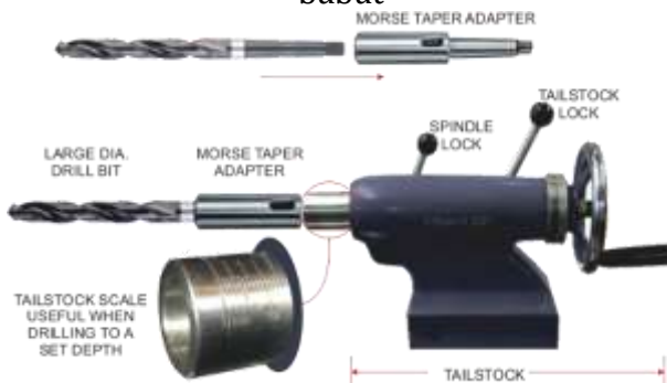
Gambar 2.126. Pemasangan mata bor pada mesin bubut menggunakan arbor
