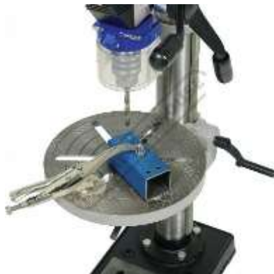
Gambar 2.156. Teknik menjepit benda kerja menggunakan tang jepit ( vice grip )
