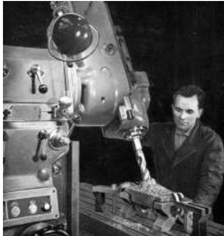
Gambar 2.111. Mesin bor radial dengan posisi pengaturan sepindel mata bor miring ( sumber : https://id.pinterest.com/ )
