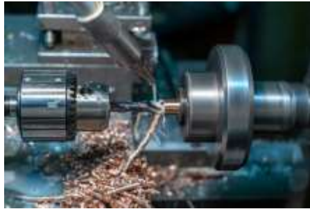
Gambar 2.128. Posisi mata bor yang dijepit menggunakan drill chuck terpasang pada tailstock (Sumber : www.istockphoto.com )
