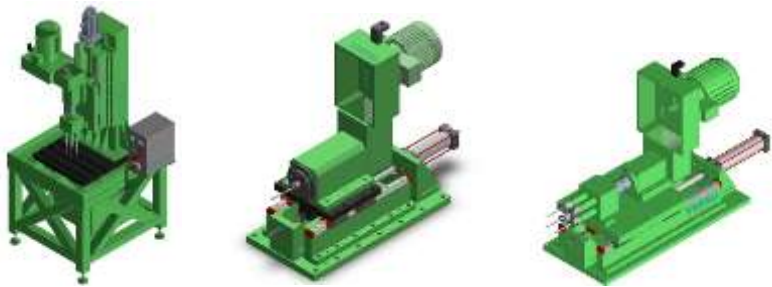
Gambar 2.104. Mesin bor multi spindle horizontal dengan feeding pneumatic/hydraulic (Sumber : https://www.prashmachines.com/ )
