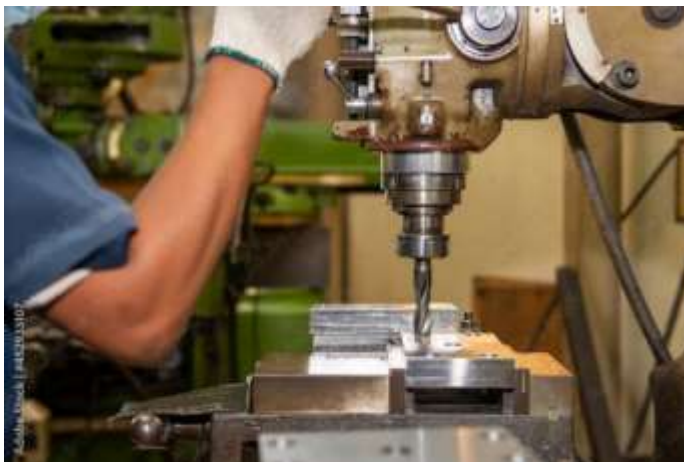
Gambar 2.114. Pengeboran dengan mesin milling ( sumber : https://id.pinterest.com/ )
