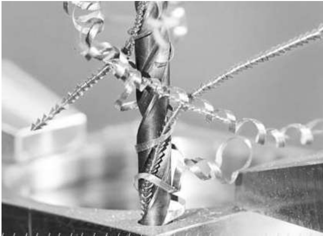
Gambar 2.90. Geram hasil pengeboran material (Sumber : Pinteres.com)
