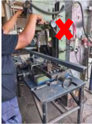
Gambar 2.154. Jangan mengebor benda kerja tapi alat penjepit
