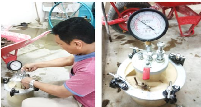
Gambar 2.6. Proses pengukuran kandungan udara beton
