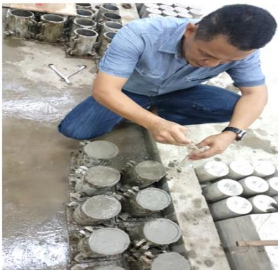
Gambar 2.5. Proses Pengukuran Kandungan Air Beton ( Bleeding )
