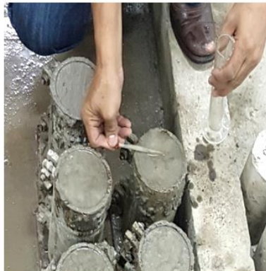
Gambar 2.5. Proses Pengukuran Kandungan Air Beton ( Bleeding )
