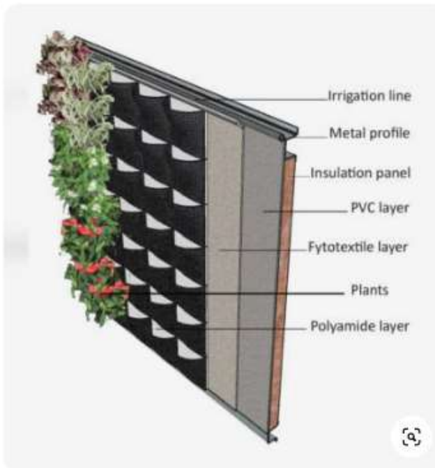
Gambar 8.6 : Konstruksi dengan sistem Kantong Sumber : Pinterest 2022
