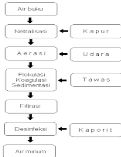
Gambar 7. 12. Proses pengolahan air gambut
