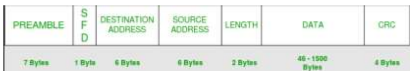
Gambar 6.3. Ethernet Frame Format (Sumber : www.geeksforgeeks.org )
