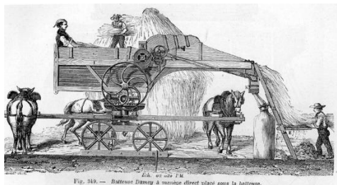
Gambar 2.5. Mesin perontok gandum yang digerakkan oleh tenaga kuda ((Sumber : Dictionnaire d'arts industriels))
