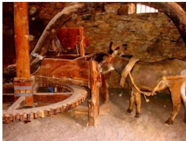
Gambar 2.4. Keledai untuk menggerakkan penggilingan biji-bijian (Sumber : www.wikipwdia.com )
