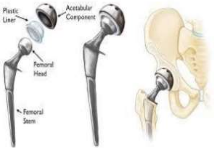
Gambar 9.2. Implan sendi panggul dari baja tahan karat (Sumber: Aherwar et al., 2015)
