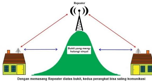
Gambar 2.12 Cara kerja Repeater
