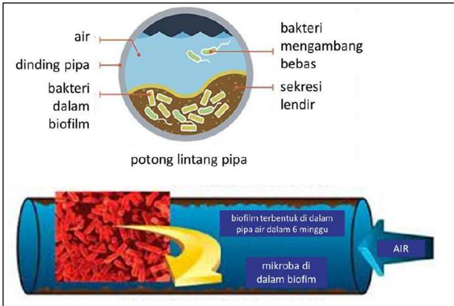
Gambar 3. 1. Munculnya biofilm dalam jaringan perpipaan
