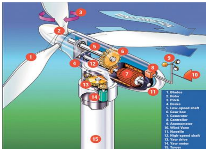
Gambar 10.2. Diagram skematik dari turbin angin (Sumber: Burton, Tony, 2001)
