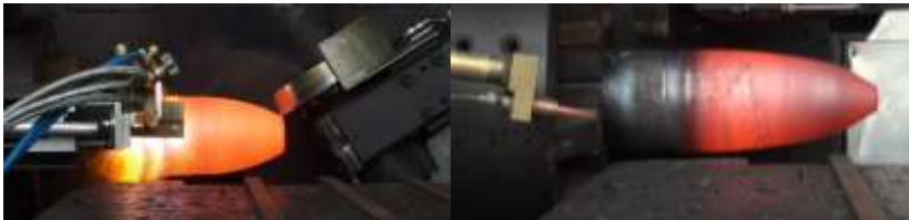
Gambar 4.25. Proses hot spinning dalam proses pembuatan proyektil peluru meriam.
