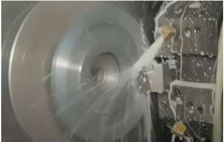
Gambar 4.30. Tahap-2 perarataan permukaan bahan menggunakan mesin bubut
