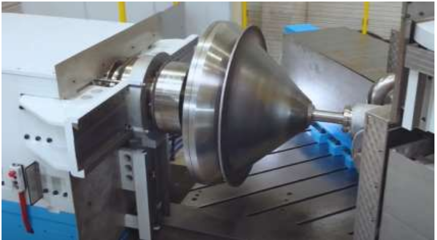
Gambar 4.23. Proses spinning alat rumah tangga berbahan stainless steel
