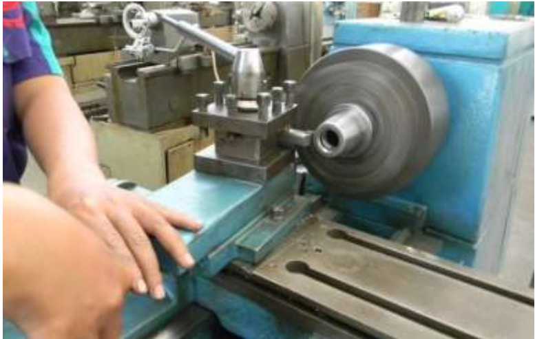
Gambar 6.47. Pembubutan tirus dengan menggeser eretan atas (Sumber : Widarto, 2008)
