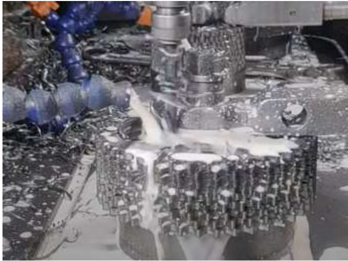
Gambar 4.34. Proses pembuatan lobang poros dan lubang baut
