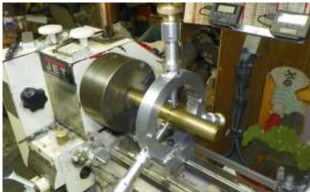
Gambar 6.60. Menahan benda kerja sebelum dipotong dengan steady rest (Sumber : Widarto, 2008)
