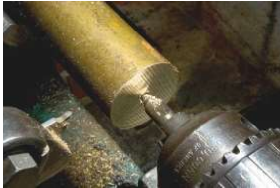
Gambar 6.39. Putaran mesin bubut harus berlawanan dengan arah jarum jam (Sumber : Widarto, 2008)
