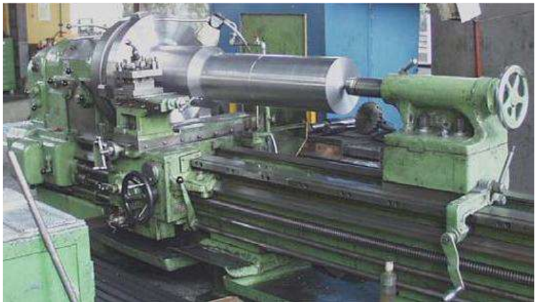
Gambar 6.42. Pembubutan lurus, benda kerja ditahan dengan senter putar (Sumber : Widarto, 2008)
