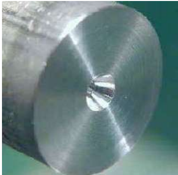
Gambar 6.40. Dimensi bor senter (centre drill) dan hasil pembubutan lubang senter bor (Sumber : Widarto, 2008)
