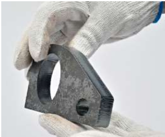
Gambar 4.17. Hasil pemotongan menggunakan CNC laser Cctting (Sumber : https://www.acmefiberlaser.com )
