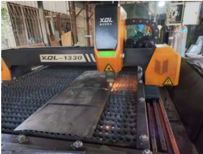
Gambar 4.13. Tahap kedua melatakan material di atas meja potong dan menentukan titik nol.
