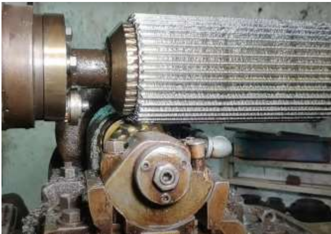
Gambar 4.33. Proses pemesinan yaitu pembuatan profile roda gigi rantai menggunakan mesin milling
