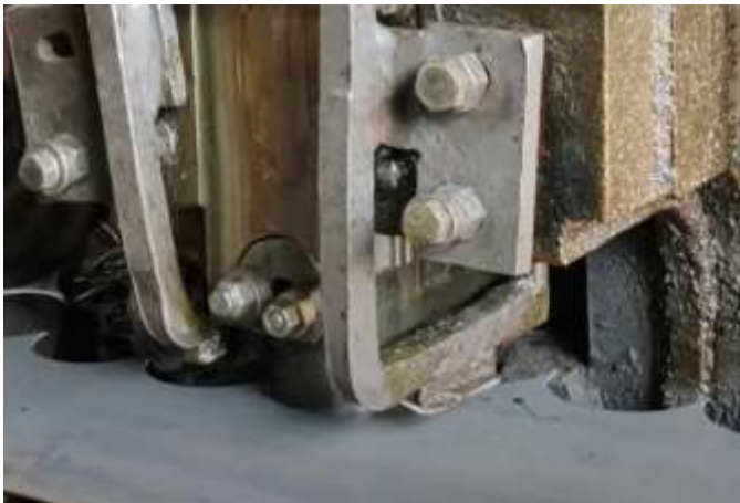
Gambar 4.29. Tahap 1-Pemotogan lembaran plat menjadi bentuk lingkaran dan pembentukan jari jari ,menggunakan mesin pond .
