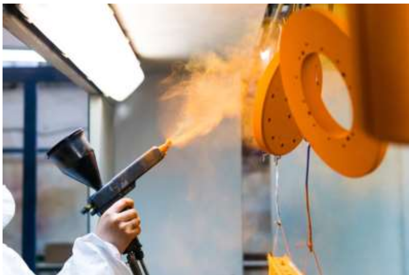
Gambar 4.39. Proses finishing dengan pelapisan powder coating (Sumber : https://coatingsystems.com/ )
