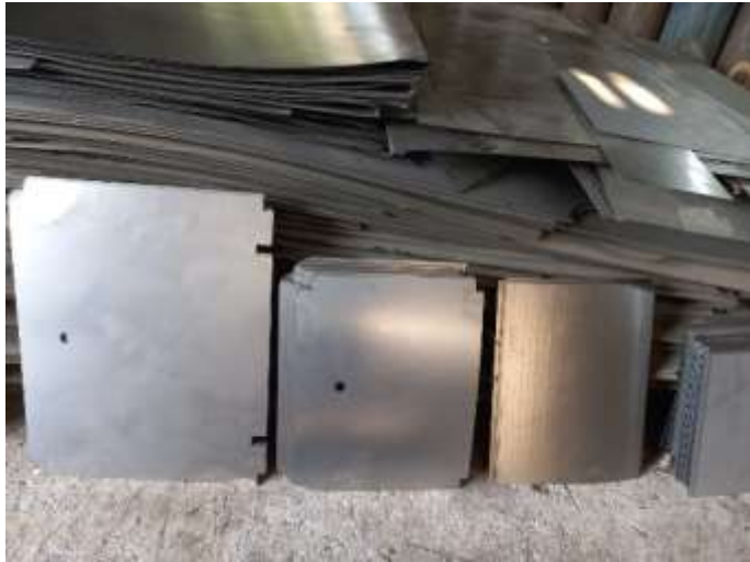
Gambar 4.14. Hasil pemotongan menggunakan mesin CNG plasma cutter
