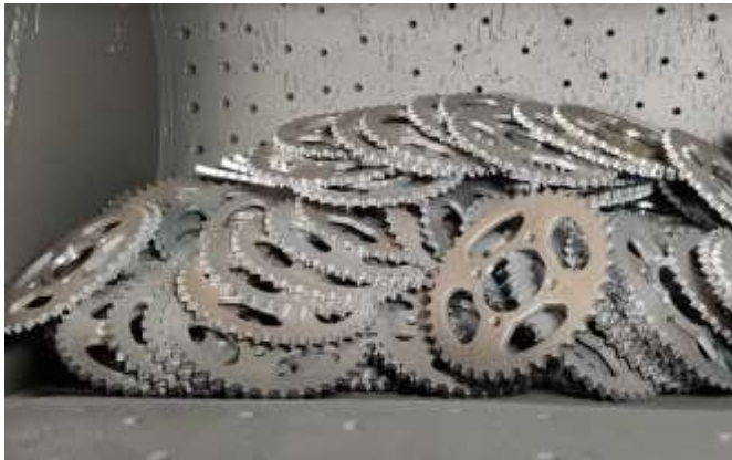
Gambar 4.35. Proses hardening menggunakan oven
