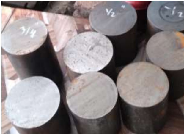
Gambar 4.8. Hasil pemotongan dengan band saw (Sumber : Koleksi penulis)
