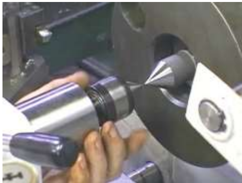
Gambar 6.36. Mengatur kesepusan sumbu senter dengan mempertemukan kedua ujung senter (Sumber : Widarto, 2008)
