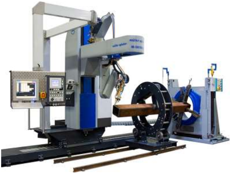
Gambar 4.18. CNC plasma cutter untuk memotong material dalam bentuk profil dan pipa dalam berbagai bentuk (Sumber : https://www.mueller-opladen.de )
