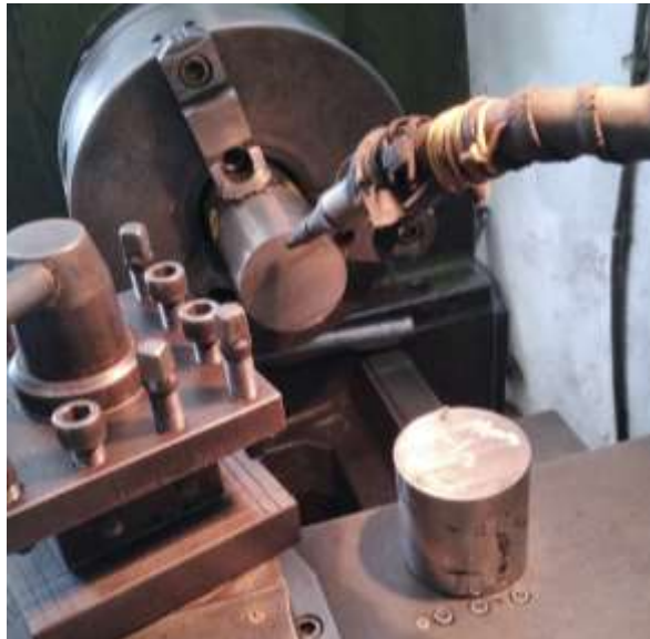
Gambar 4.9. Material yang telah dipotong menggunakan band saw selanjutnya dilakukan proses pembubutan (Sumber : Koleksi penulis)
