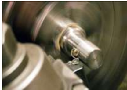
Gambar 6.71. Melakukan pemakanan ulir (Sumber : Widarto, 2008)
