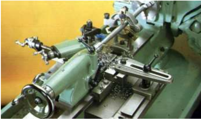
Gambar 6.43. Pembubutan lurus benda kerja ditahan dengan senter putar dan tengahnya ditahan dengan steady rest (Sumber : Widarto, 2008)
