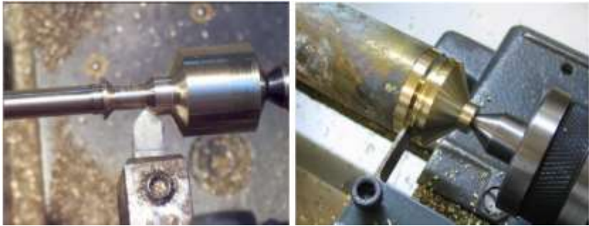
Gambar 6.53. Pengaluran benda kerja dengan pendukung senter putar (Sumber : Widarto, 2008)
