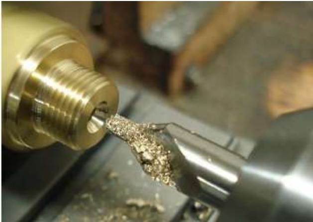
Gambar 6.33. Pembubutan lubang senter pada permukaan ujung benda kerja (Sumber : Widarto, 2008)
