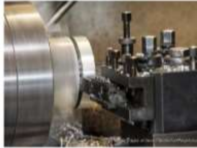
Gambar 6.58. Proses pemotongan benda kerja berukuran pendek. (Sumber : Widarto, 2008)
