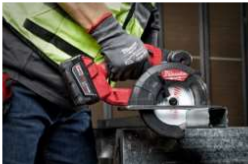
Gambar 4.6. Contoh jenis mata potong dan mesin gergaji circular untuk memotong aluminium (Sumber : Milwaukee tools)
