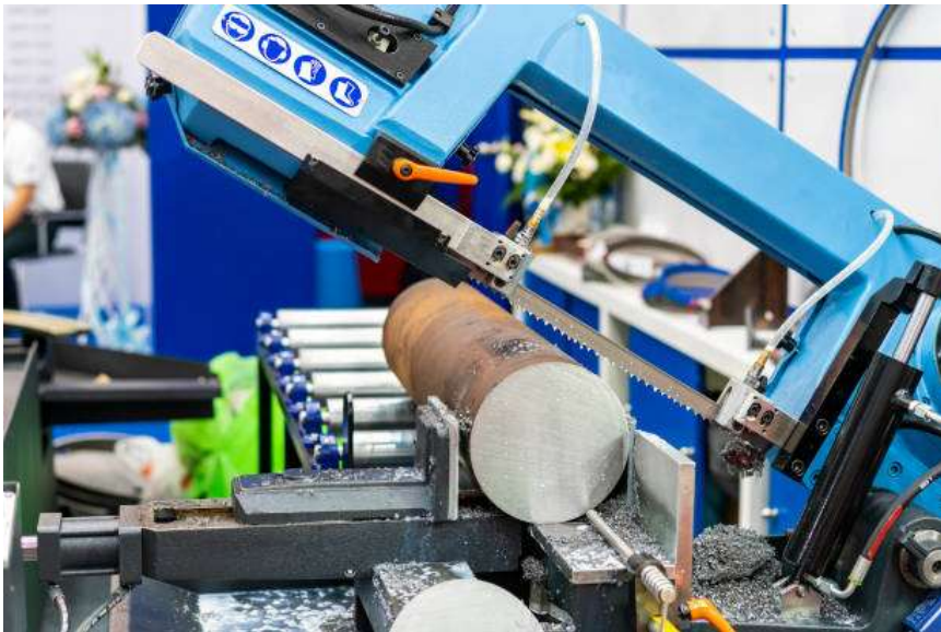
Gambar 4.7. Material besi bulat dengan diameter 100mm sedang dipotong menggunakan band saw ( mesin gergaji pita/sabuk) (Sumber : https://www.istockphoto.com/ )
