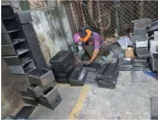
Gambar 4.16. Proses pembentukan panel melalui proses pengelasan
