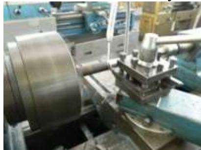
Gambar 6.69. Pembubutan benda kerja yang akan di ulir (Sumber : Widarto, 2008)
