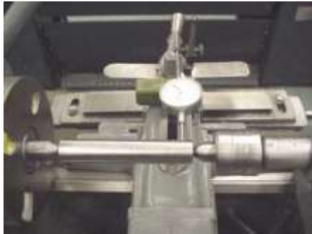
Gambar 6.35. Mengatur kesepusan sumbu dengan alat bantu batang pengetes dan dial indikator (Sumber : Widarto, 2008)
