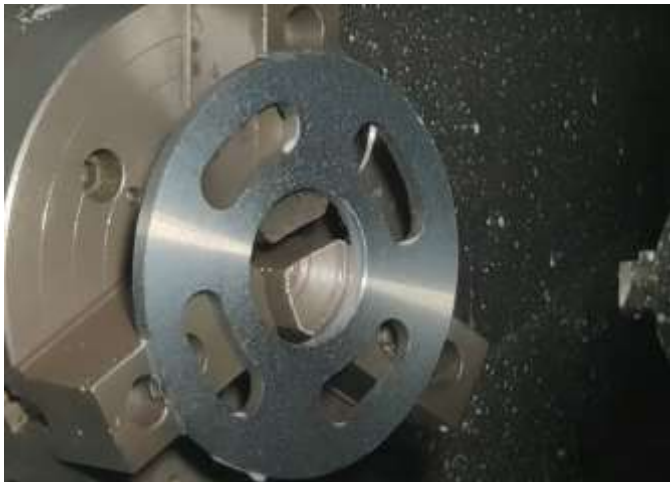
Gambar 4.31. Hasil pelat ang telah dibubut permukaannya
