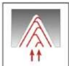
Gambar 6.63. Metoda pemotongan ulir dengan cara zig-zag (Sumber : Widarto, 2008)
