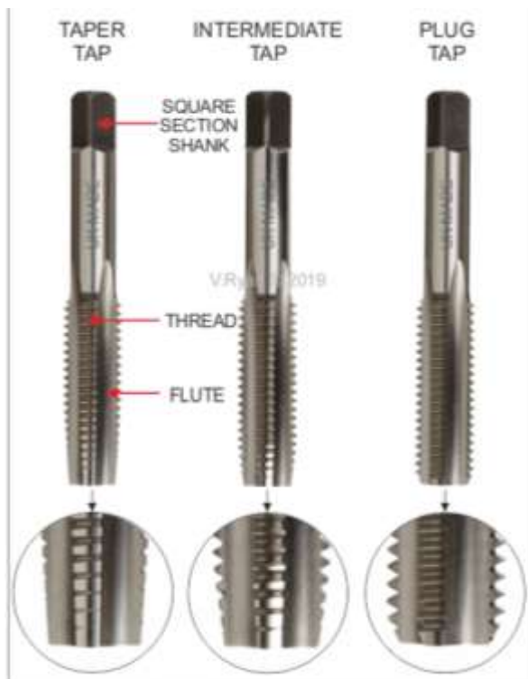
Gambar 2.9. Satu set Tap yang digunakan pada pembuatan ulir dalam terdiri dari ; (a) Tap Taper (b) Tap intermediate (c) Tap Plug (Sumber : Ryan, 2019)
