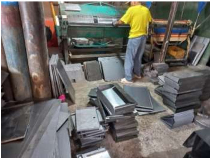
Gambar 4.15. Pelat yang sudah dipotong kemudian dilakukan proses bending (tekuk)
