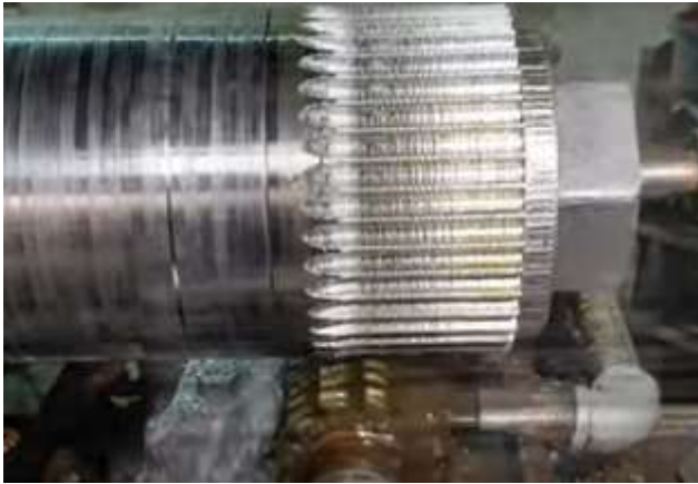
Gambar 4.32. Pelat yang telah diratakan kemudian dijadikan satu sesuai dengan kapasitas mesin milling untuk dilakukan pembuatan profil roda gigi rantai
