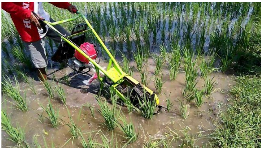
Gambar 190. Pembersihan tanaman pengganggu pada padi menggunakan mesin penyang gulma
