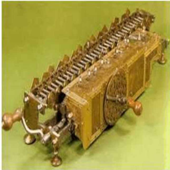
Gambar 2.4 : Tampilan Dari Stepped Reckoner Atau Leibnitz Wheel
