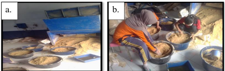
Gambar 3. 4. Campuran hasil mixing yang siap dicetak, a. Campuran tersimpan di ember bak, dan b. Proses pencampuran sedikit air dan minyak sayur
