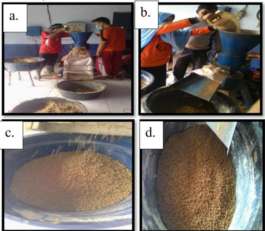
Gambar 3. 5. Proses pencetakan pelet tenggelam dan hasil cetakan., a. Pencetakan pakan size 3 mm., b. Pencetakan pakan size 4 mm., c. Pelet size 3 mm, dan d. Pelet size 4 mm
