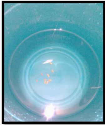
Gambar 3. 9. Proses pengujian daya tahan pakan ikan size 4 mm dan 3 mm dalam air
