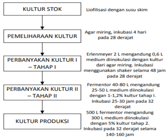
Gambar 7.3. Perbanyak inokulum Skala Pilot Fermentasi Vitamin B12 Menggunakan Pseudomonas aeruginosa (Sumber: Astuti, 2009)
