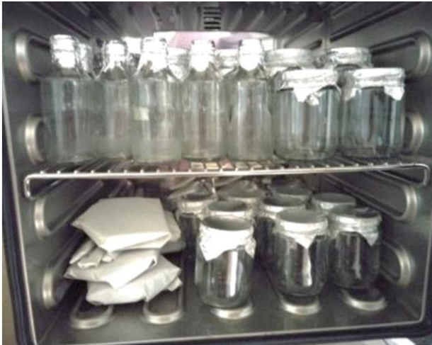
Gambar 3.1. Oven Sterilisasi Metode panas kering Sumber (Wulandari et al. , 2022).
