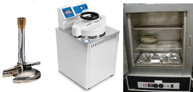
Gambar 3.2. Sterilisasi panas uap bertekanan ( Autoclave ) dan panas kering (pemijaran dan oven)
