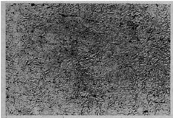
Gambar 4. 8. Microstruktur hasil Pengerasan Presipitasi (Tsukamoto, 1959).
