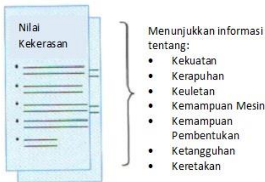
Gambar 5. 4. Hubungan sifat kekerasan dengan sifat mekanis logam yang lain (Brandt, 2005)
