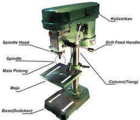
Gambar 4.30. Mesin bor serta bagian-bagiannya sumber: https://dayacipta.co.id/dnews/16/bagian-bagian-mesin-bor-dan-fungsi.html
