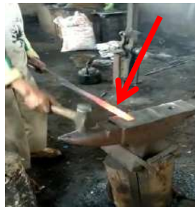
Gambar 4.9. Pembuatan peralatan pertanian dengan menggunakan metode penempaan
