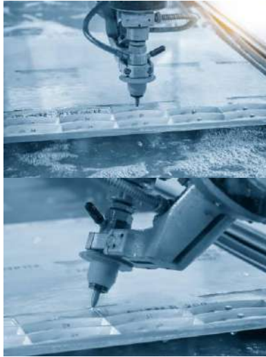
Gambar 5.14. Pemotongan plat aluminium dengan waterjet. (Sumber: phuchit melalui istock)
