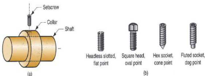
Gambar 4.41. a) Perakitan pad poros dengan menggunakan screw; (b)Berbagai jenis geometri screw (type titik dan kepala screw).
