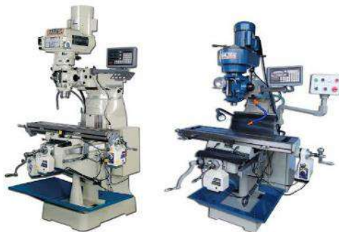
Gambar 5.7. Mesin Frais (Milling) dengan jenis vertikal. (Sumber: Esquire)
