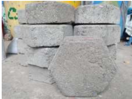
Gambar 4 Paving blok olahan butir plastik
