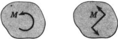
Gambar 8.7 momen kopel berlawanan arah dengan jarum jam (Sumber : Mekanika Teknik)
