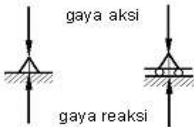
Gambar 8.12. gaya aksi dan reaksi (Sumber buku SMK Mekanika Teknik)
