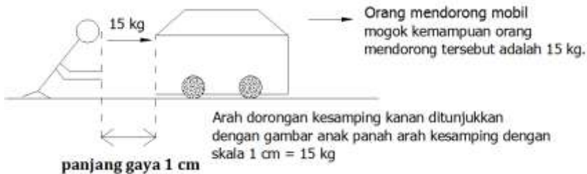
Gambar 7.4. Contoh 3 Analisa Gaya (Sumber : Suwarno, 1985)
