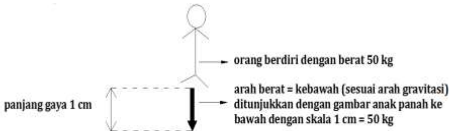
Gambar 7.2. Contoh 1 Analisa Gaya (Sumber : Suwarno, 1985)'
