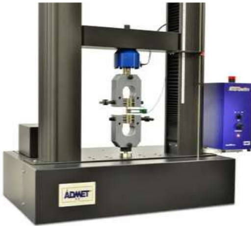
Gambar 10.8. Pengujian Modulus Bahan Struktural ASTME111 Sumber. Admec, Inc
