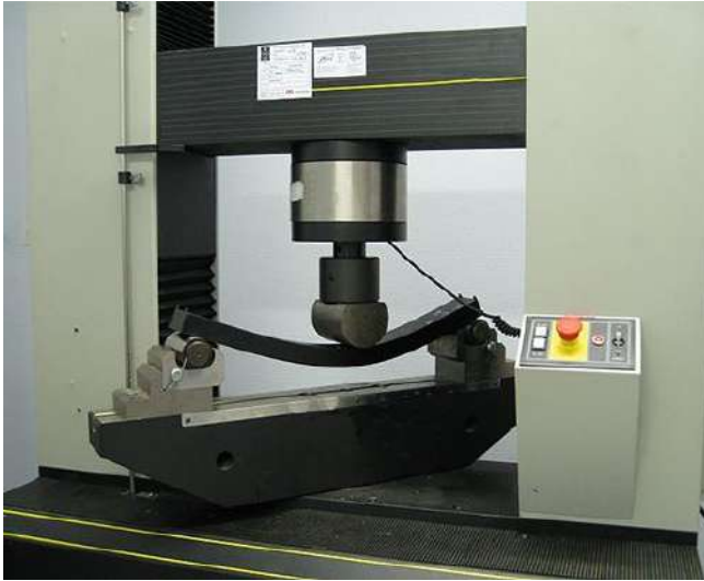
Gambar 9.2. Mesin Uji Bending (Sumber : https://testingindonesia.co.id/10-pengujian-menggunakan-alat-universal-testing-machine/ )
