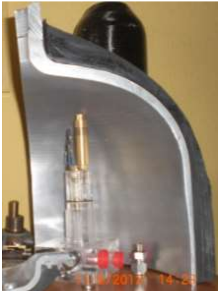
Gambar 8.45. Hasil potongan memperlihatkan lapisan composite yang melekat pada cylinder aluminium type-3 (Sumber : Dokumen pribadi)
