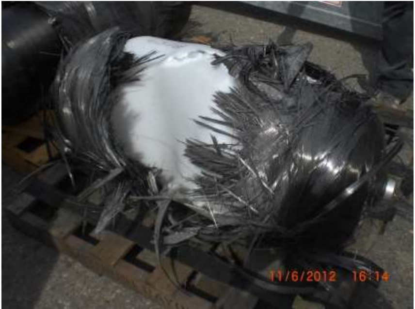
Gambar 8.36. Tabung CNG type-4 yang hasil uji yang telah rusak di pabrik Dynetek-Jerman (Sumber : Dokumen pribadi )
