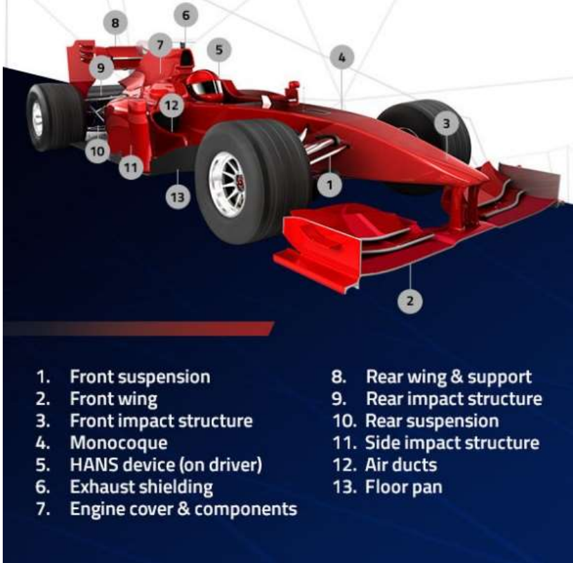
Gambar 8.42. Komponen mobil Formula-1 menggunakan komposite untuk mengurangi bobot kendaraan dan meningkatkan kekuatan
