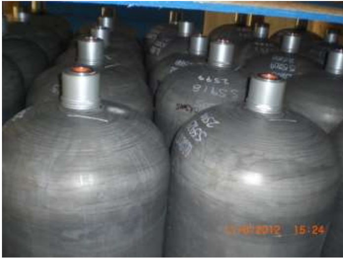
Gambar 8.46. Silinder aluminium sebelum dilakukan wrapping menggunakan serat komposit + resin (Sumber : Dokumen pribadi)
