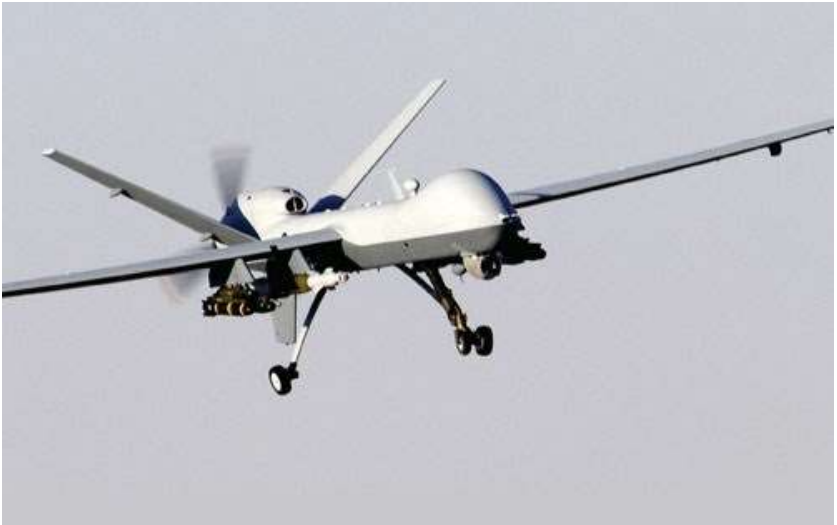
Gambar 8.41. Pesawat unmanned aerial vehicle (UAV) , pesawat tanpa awak menggunakan bahan komposit agar tidak terdeteksi oleh radar.
