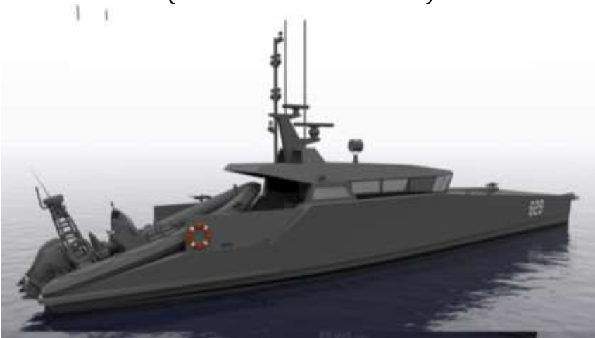
Gambar 8.51. X3200 Long Range Patrol Boat, kapal buatan Indonesia dengan bodi komposit. (Sumber : PT Lundin Industry Invest)
