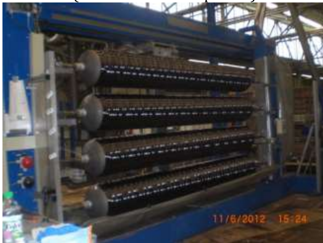
Gambar 8.47. Proses spinning atau wrapping pada pembuatan CNG cylinder type 3 di pabrik Dynetek- Jerman (2013) (Sumber : Dokumen pribadi )
