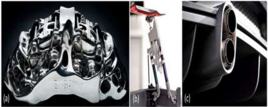
Gambar 6.3. Titanium di sektor otomotif (a) kaliper rem monobloc delapan piston (b) braket spoiler aktif dan (c) penutup trim pipa knalpot. (Sumber: (Nyamekye et al., 2023))
