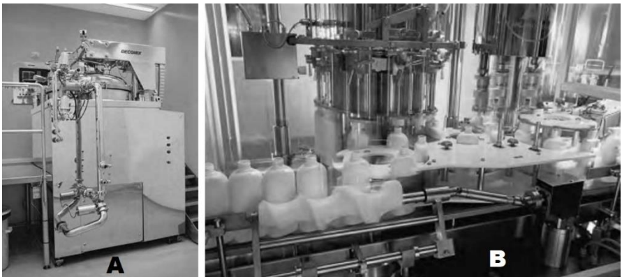
Gambar 3.3. Mikser untuk sistem dispersi (A), pengisian sediaan cair dalam botol (B) (Sumber: Allen dan Ansel, 2015)
