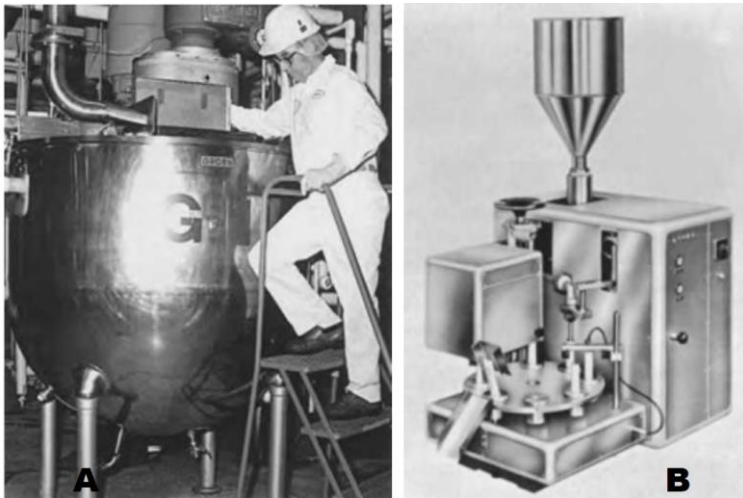
Gambar 3.2. Tangki baja tahan karat untuk pembuatan salep dan krim dengan batch sampai 1500 kg (A), mesin pengisi sediaan semipadat ke dalam tube (B). (Sumber: Allen dan Ansel, 2015)
