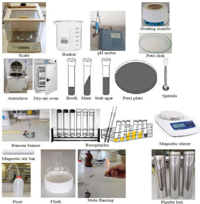
Gambar 3.1. Peralatan dan sarana penunjang yang digunakan dalam kultur jaringan tanaman (Volk et al. , 2022)
