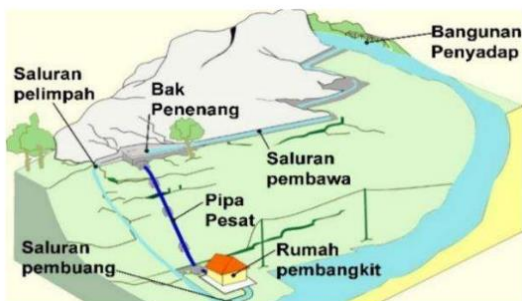
Gambar 3.7. Skema Pembangkit Listrik Tenaga Air (Sumber : (Astro et al., 2020))
