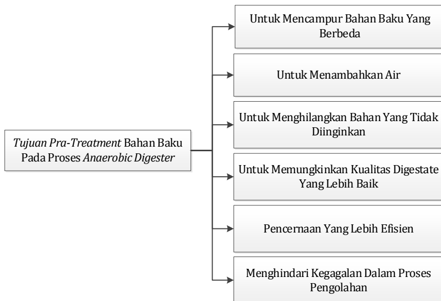
Gambar 6.2 Tujuan Dilakukannya Pra-Treatment Bahan Baku pada Proses Anaerobic Digester
