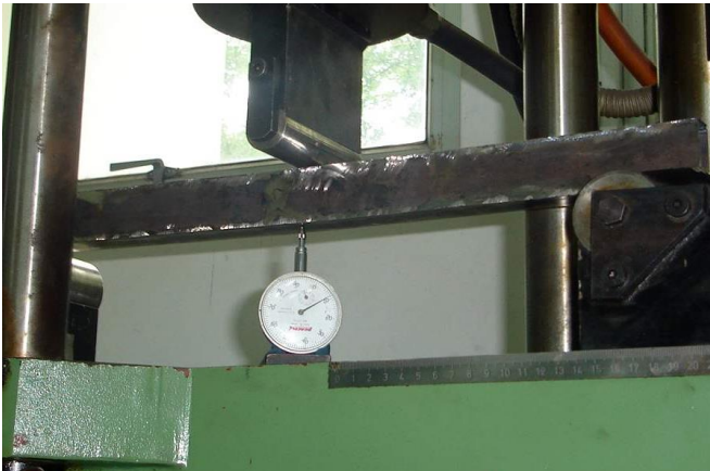
Foto Saat Dilakukan Uji Tekan
