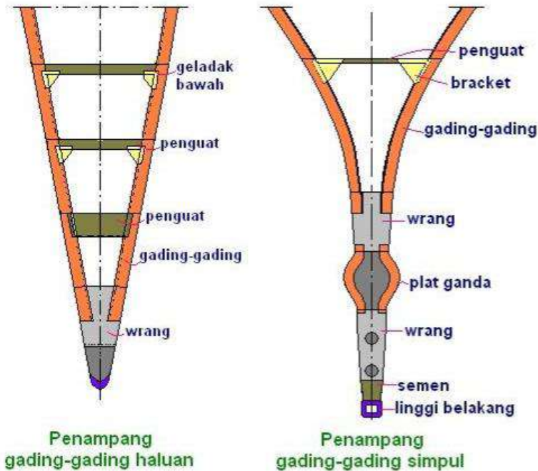
Gambar 3. 2. Penampang gading-gading kapal
