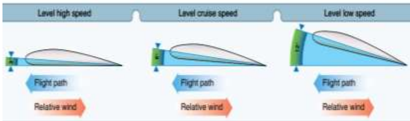
Gambar 3.5. Ilustrasi variasi nilai angle of attack pesawat terhadap kecepatan. (Sumber : Pilot's Handbook of Aeronautical Knowledge, 2016)
