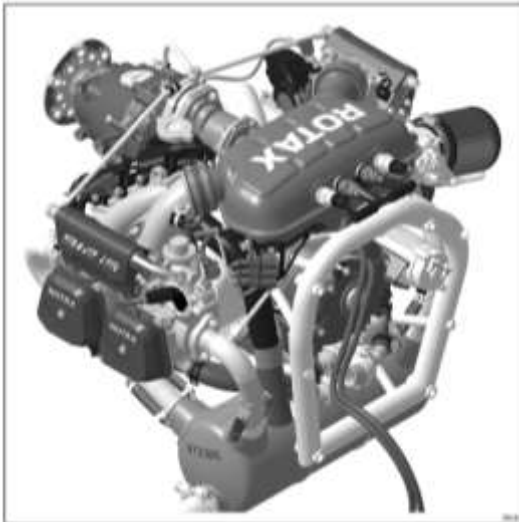
Gambar 8.103. Mesin pesawat ringan Rotax 4 cylinder (Sumber : Rotax)
