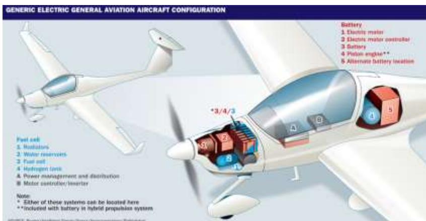
Gambar 8.140. Contoh pesawat kecil jenis penerbangan umum, yang ditenagai oleh motor listrik yang menggerakkan baling-baling. (Sumber : https://oer.pressbooks.pub/ )
