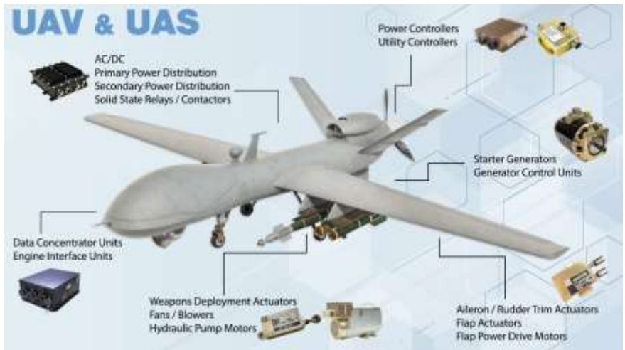
Gambar 8.145. Bagian-bagian dari UAV ( https://www.nasa.gov/ )
