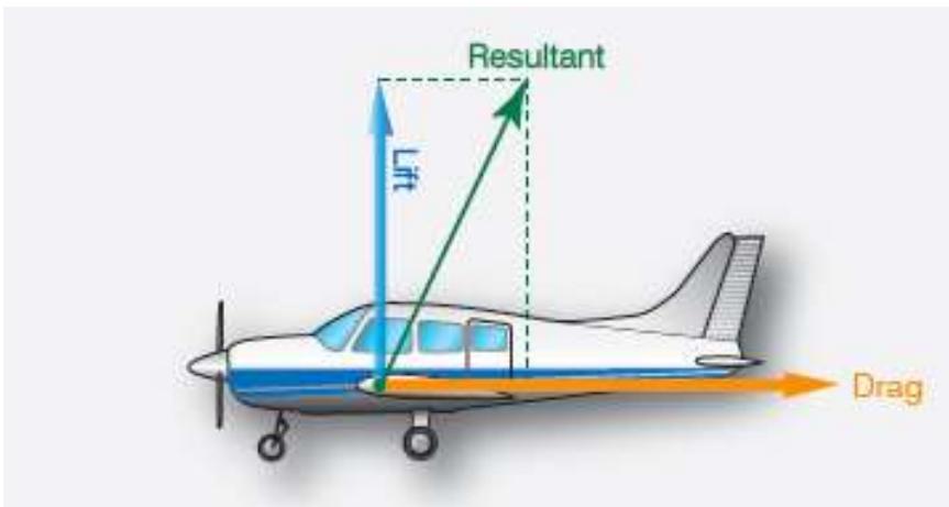
Gambar 7.2. Daya Dorong, Daya Angkat Dan Daya Hambat (Sumber: (FAA, 2018))
