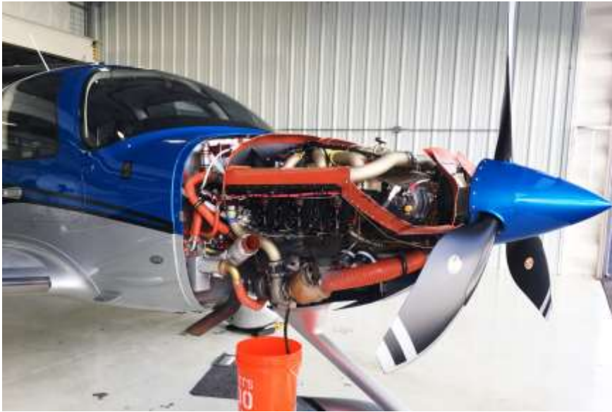
Gambar 8.111. Mesin piston dipasang pada hidung pesawat (Sumber : Lycoming)
