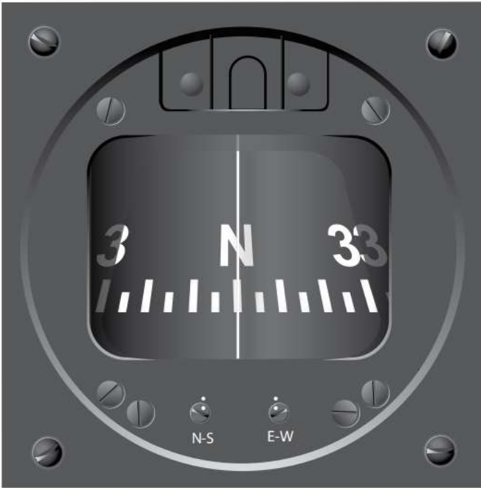
Gambar 2.83. Kompas magnetik yang digunakan sebagai alat penunjuk arah di pesawat terbang. (Sumber: [U.S. Department of Transportation, 2016])
