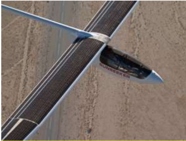
Gambar 8.147. Pesawat terbang dengan solar cell Sunseeker II (Sumber : https://www.solar-flight.com/ )
