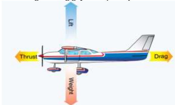
Gambar 3.1. Gaya-gaya yang bekerja pada pesawat terbang (Sumber : Pilot's Handbook of Aeronautical Knowledge, 2016)
