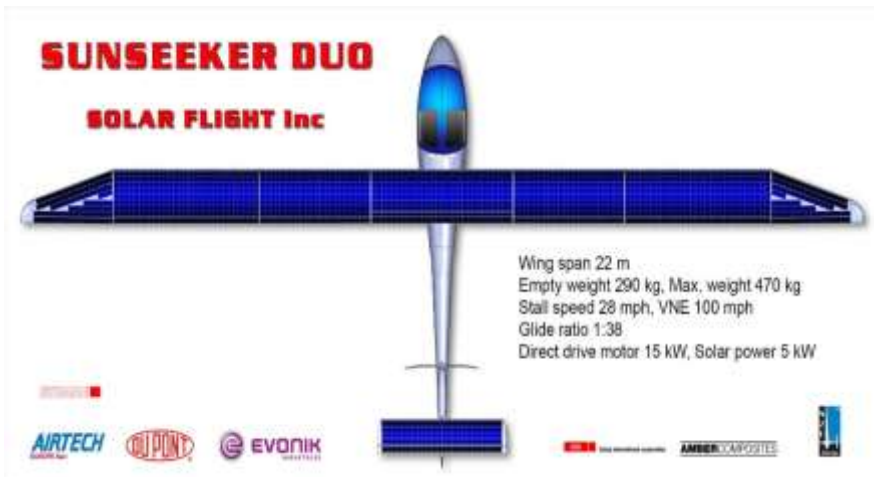
Gambar 8.148. Pengembangan pesawat dengan tenaga surya SunseekerDuo (Sumber : https://www.solar-flight.com/ )
