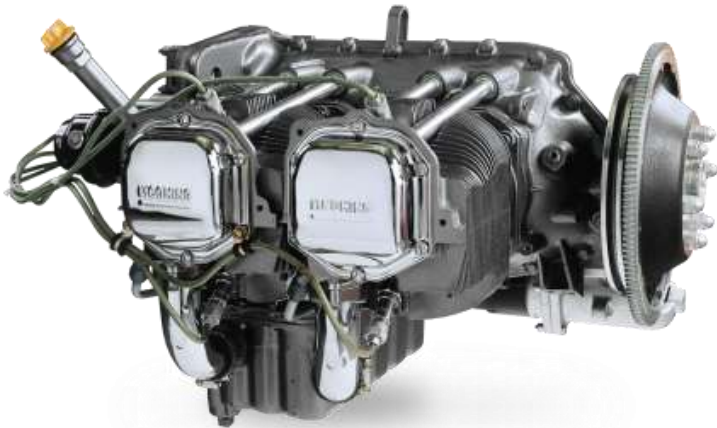
Gambar 8.102. Mesin penggerak 4 langkah, 4 cylinder. (Sumber : Lycoming)
