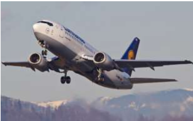
Gambar 8.124. Pesawat Boeing 737 bermesin turbofan buatan CFM.
