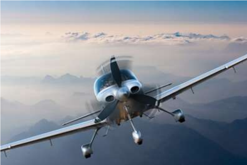
Gambar 8.94. Ilustrasi pesawat dengan pendorong baling baling, udara dari depan pesawat didorong oleh baling baling ke belakang pesawat sehingga pesawat dapat bergerak. (Sumber : southernwing)
