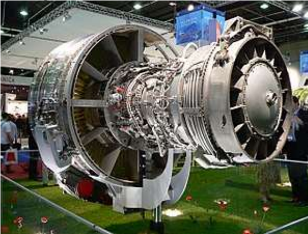
Gambar 8.123. Turbofan CFM56 sebagai mesin pendorong pesawat berbadan besar. (Sumber : CFM International)
