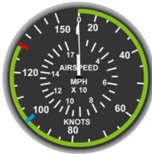
Gambar 2.81. Ilustrasi Air Speed Indicator dengan satuan Knots dan MPH (Sumber: [Croucher, 2007])
