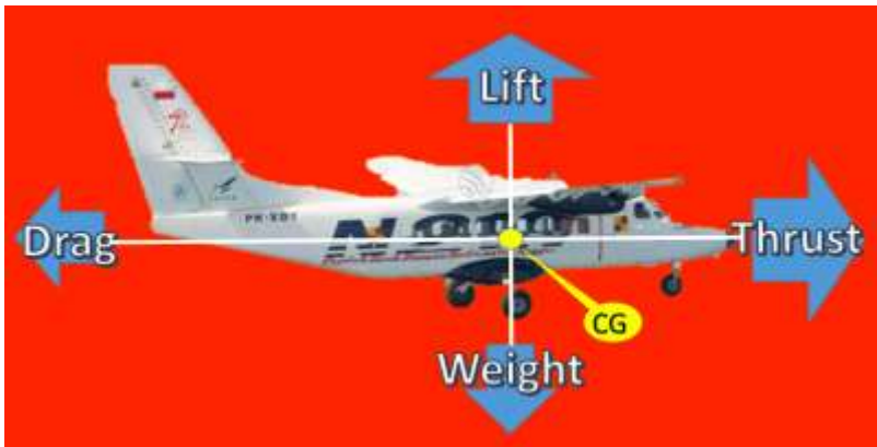
Gambar 7.1. Empat gaya: berat, daya angkat, daya hambat, dan daya dorong (Sumber: (Fatkhulloh, 2021))
