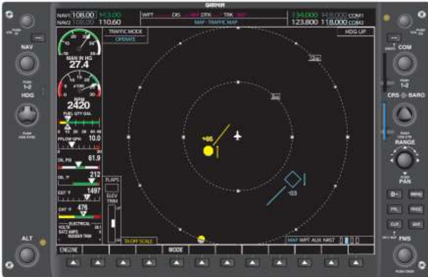
Gambar 2.90. Antar muka digital dan multi fungsi yang saat ini banyak digunakan di pesawat(Sumber: [U.S. Department of Transportation, 2012])
