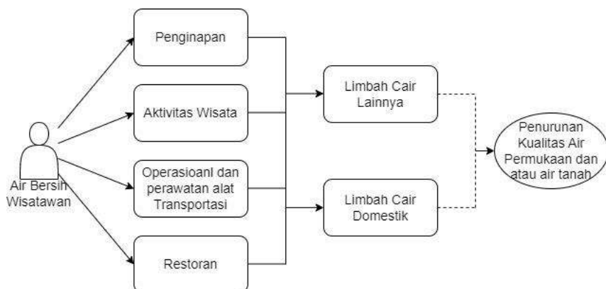
Gambar 7.4. Alur Produksi Limbah Cair
