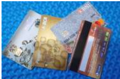
Gambar 8.13. Kartu ATM dengan magnetic stripe (jalur magnet).
