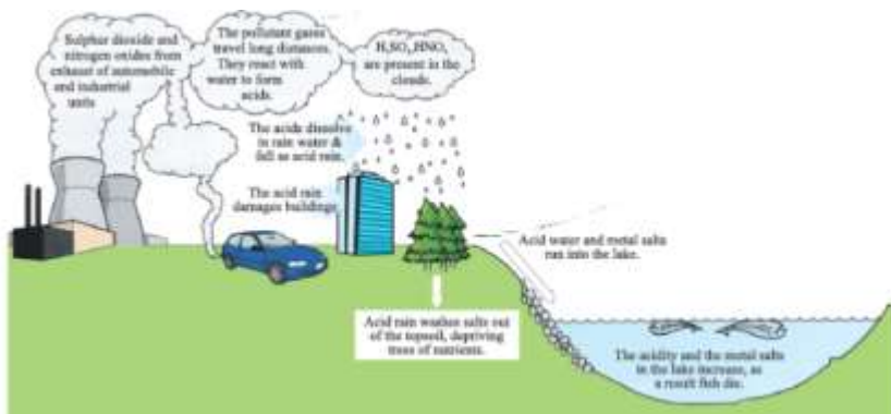
Gambar 12.3. Proses oksida sulfur dan nitrogen menjadi asam
