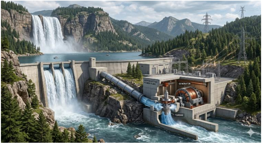
Gambar 4.1. Ilustrasi air terjun dan bendungan dengan energi potensial berubah menjadi energi kinetik saat menuju turbin. (Sumber : dibuat dengan Gemini).
