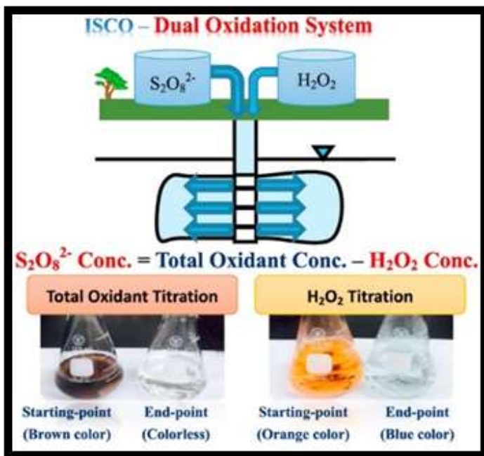
Gambar 10.1. In Situ Chemical Oxidation (ISCO) persulfat dan hidrogen peroksida sebagai oksidan (Sumber: Liang, Chenju & Boyu He, 2018)
