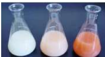
Gambar 7. 4. Proses pembentukan endapan selama proses titrasi dengan Metode Mohr
