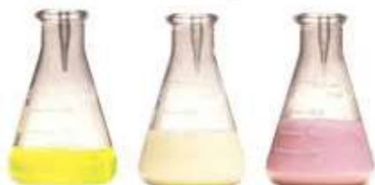
Gambar 7.6. Proses pembentukan endapan selama proses titrasi dengan Metode Fajans
