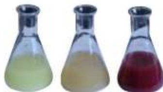
Gambar 7. 5. Proses pembentukan endapan selama proses titrasi dengan Metode Volhard
